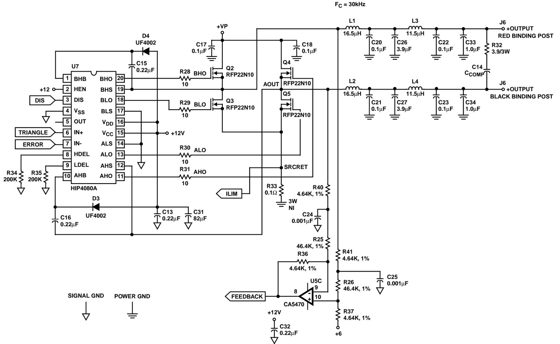
FIGURE 20. SCHEMATIC
